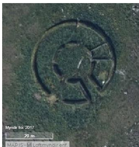
Mynd 25. Eins og vel sést úr lofti er Kleifarrett fullkomlega hringlaga. Almenninur og útveggir eru torfhlaðnir en spilverk á milli dila hefur verið úr timbri (timburflekum eða -grindum). Þá var hægt að fjölga og fækka dilkunum eftir þörfum með smá tilfærslum. Innrekstrargangurinn er hlaðinn. Þarna er fremur erfitt aðhald en ekki var sjáanleg nokkur girðingar- eða garðsleif sem hefði mátt búast við, til að stýra fjársafninu inn í innrekstrarganginn. Bilin á innri hringnum vísa til dyra á milli almennings og dila /Ljósm.Loftmyndir ehf. 20
