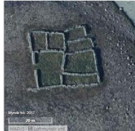
Mynd 116. Hofsrett er ferhyrnd að lögun og virðist hafa verið hlaðin upp eftir þörfum og fjárfjölda. Hún var notuð fyrir Hofsbæina fram yfir miðja 20. öld. Grjótið í hana var týnt upp af eyrunum í kring og réttin hlaðin úr þurru grjótinu/Ljósm.SS-2003 og Loftmyndir ehf. 74
