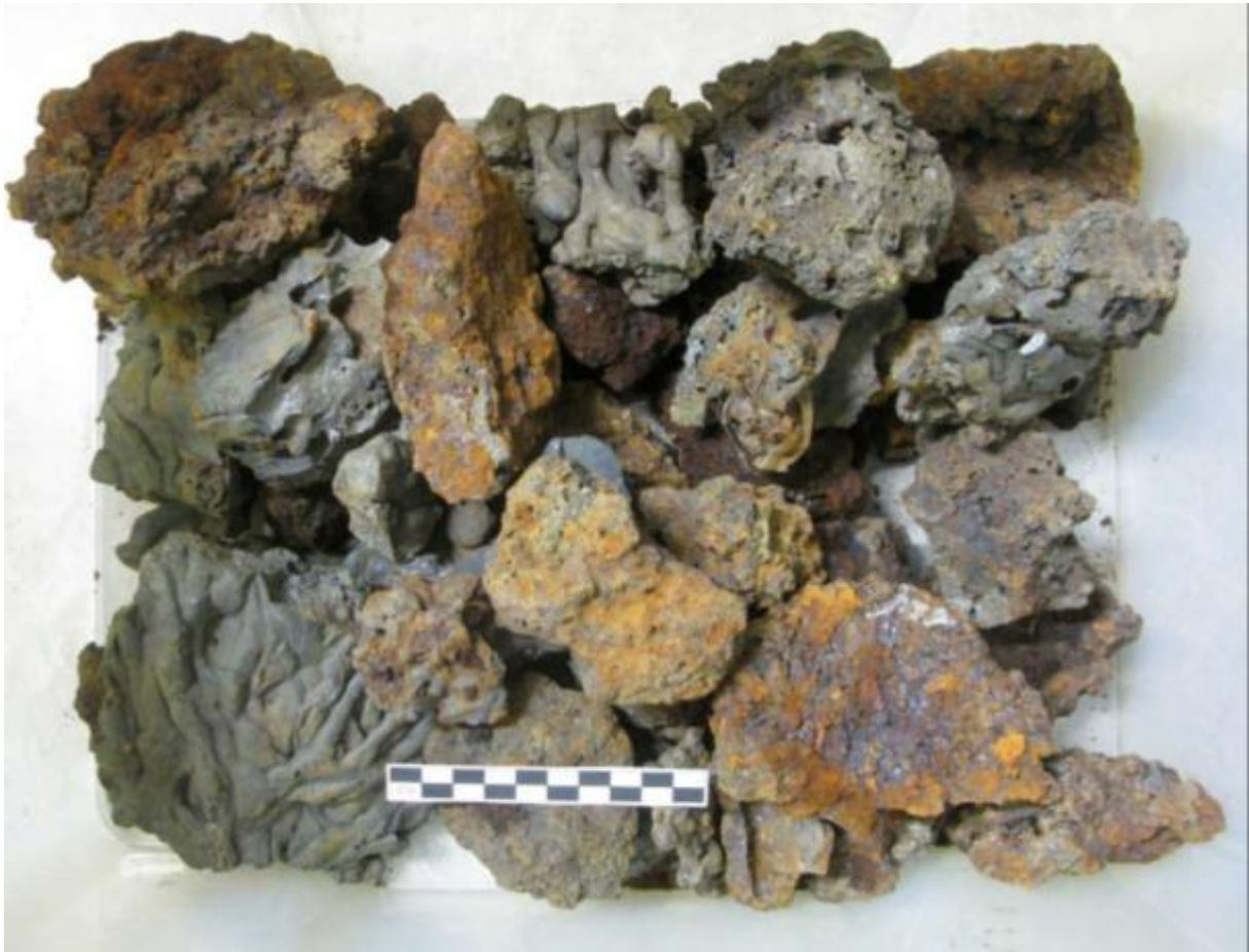
Mynd 77. Sýnishorn af mismunandi gjalli úr gjallhaugnum. Fig. 77. Samples of different kinds of slag from the slag heap.
